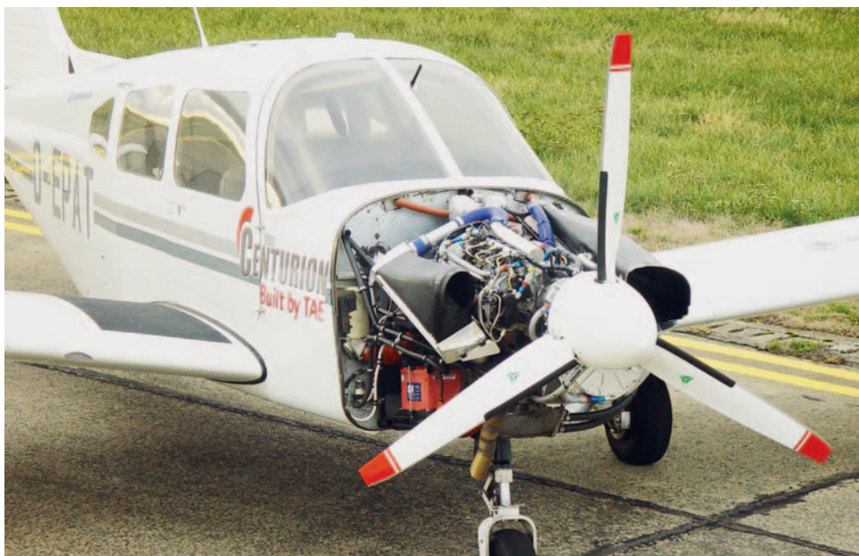
1 Dieseltechnologie in der Allgemeinen Luftfahrt: Die »Piper PA 28« mit »Centurion«-Kerosin-Kolbenflugmotor von Thielert glänzt gegenüber der Benzinmotorvariante durch bis zu 60 Prozent geringere Betriebskosten
