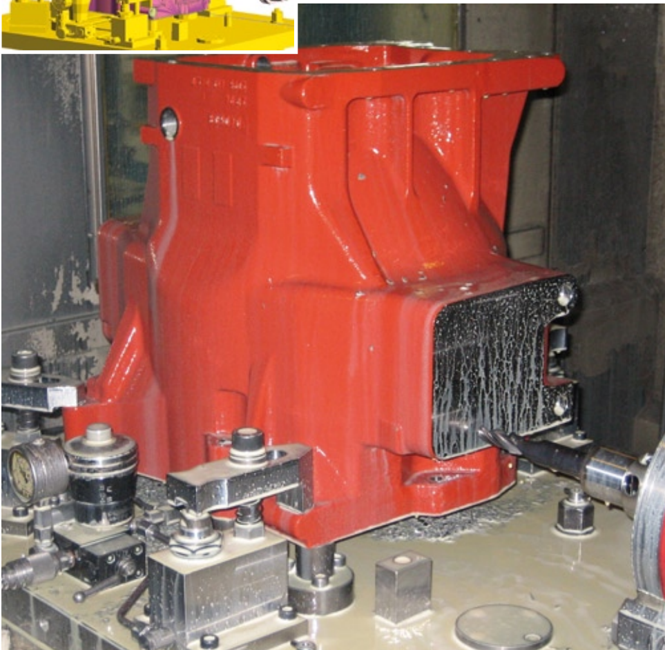
Im Prozess: Dreh- und Fräsbearbeitung eines Traktorengehäuses.
